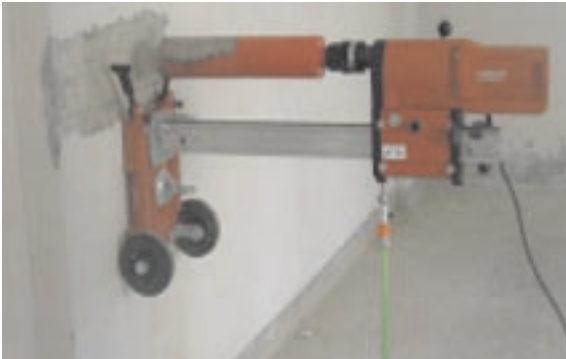
Şekil 1 - Karot makinesi ve numune alımı
