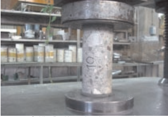
Şekil-3 Başlık yapılmış karot numune
